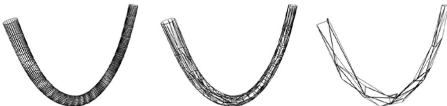
**Figura 2.17.** Fallo del modelo *multiresolución* para representar sólidos.
