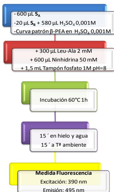
**Figura 2.6.** Esquema general de la técnica empleada para la medida de  $\beta$ -feniletilamina.
