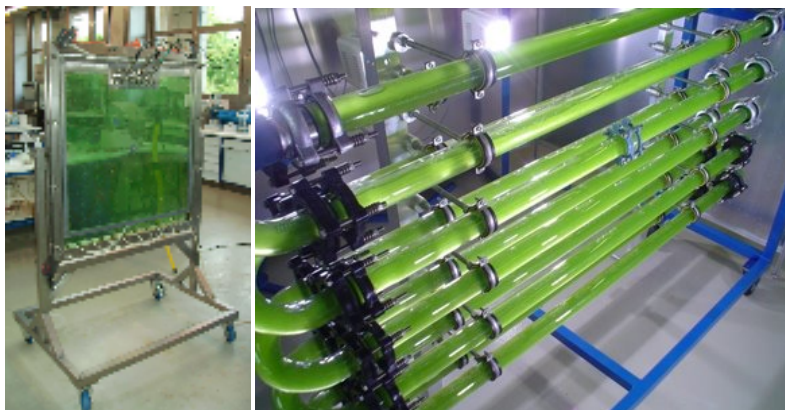
Figura 2.11. Reactores cerrados, plano y tubular
