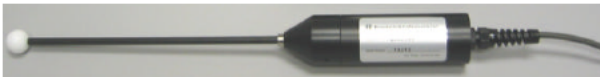
Figura 3.6 Sensor para la medida de la iluminación
