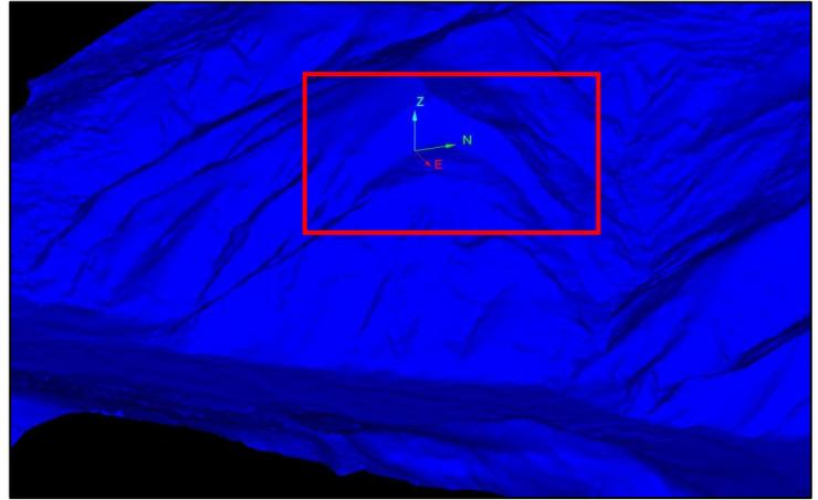
**Figura 24** Modelo Digital del Terreno de 2008 (crecimiento del escarpe y desplazamiento de la masa). El movimiento sigue activo (Fernández et al. 2011)
