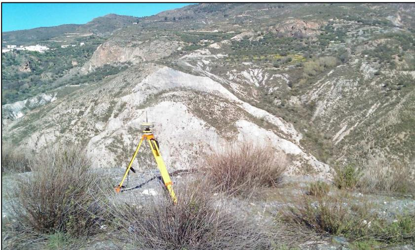
**Figura 31** Determinación de la posición de los puntos de análisis mediante receptor GNSS
