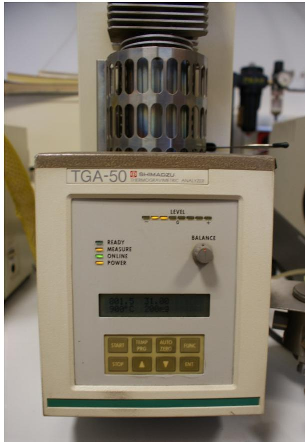
Figura 32. Analizador Termogravimétrico TGA-50H (SHIMADZU)
