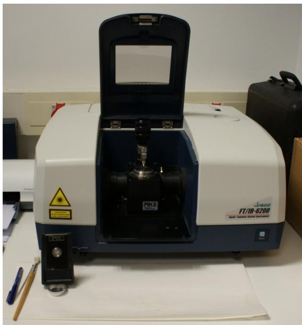
**Figura 25.** Espectrofotómetro Infrarrojos por Transformada de Fourier FT/IR-6200 (JASCO, Essex, UK)
