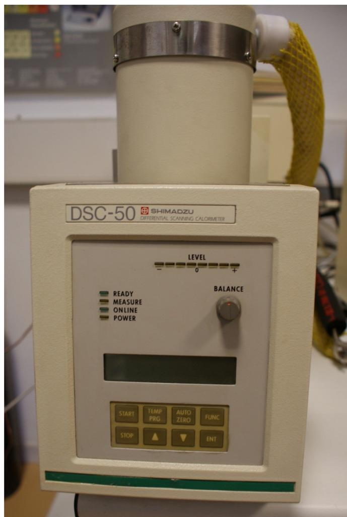
**Figura 33.** Calorímetro diferencial de barrido modelo DSC-50Q (SHIMADZU)
