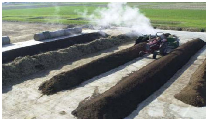
Fotografía 1.7.- Sistema abierto de compostaje (Fernández-Arroyo, 2007).
