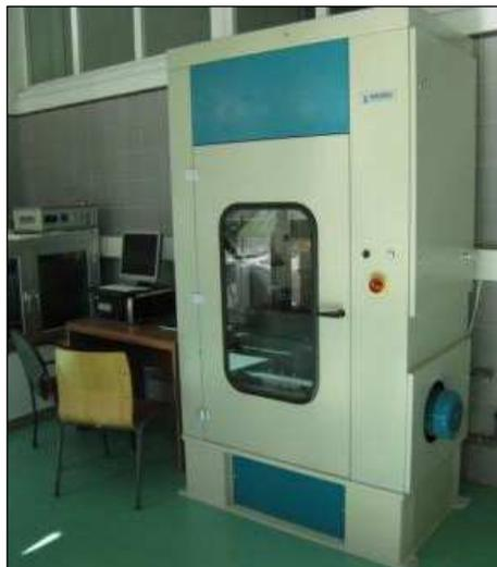
Figura 23. Compactador Segmentos de Rodillo
