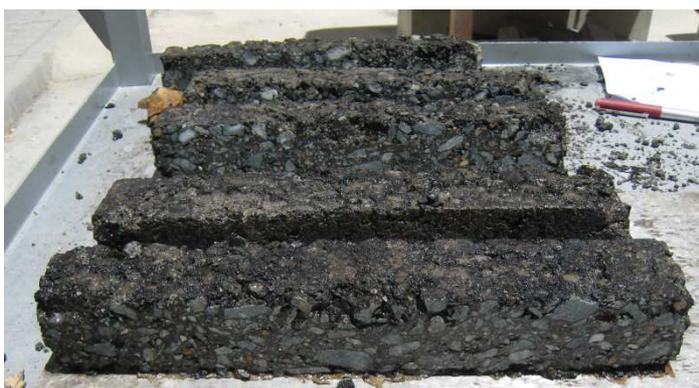
Figura 29. Probetas paralelepípedas defectuosas
