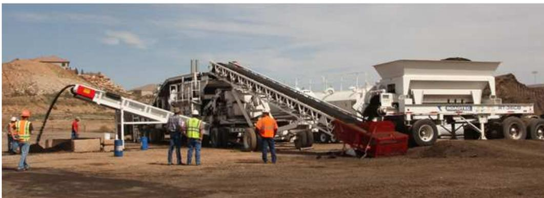
**Figura 7. Planta de reciclado en frío**
