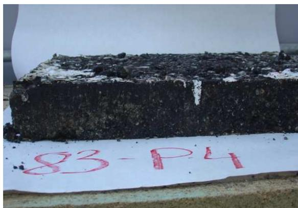
Figura 44. Deterioros en la probeta
