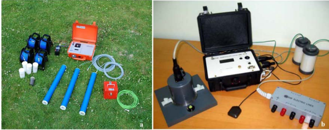
Figura 3-2: Equipos utilizado en la adquisición de datos magnetotélúricos; a) equipo de Broadband Metronix ADU-07 y b) equipo de largo periodo LEMI- 417.
