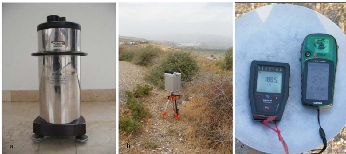
Figura 3-3: Equipo utilizado para la adquisición de datos gravimétricos en el campo: a) Gravímetro Worden modelo Master, b) Gravímetro Scintrex Autograv modelo CG-5, c) GPS modelo Garmin e-trex y altímetro barométrico.
