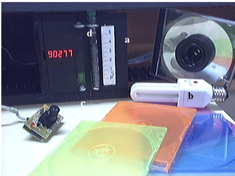
**Figura 2.4.** Elementos del sistema diseñado para el registro fotográfico de la sedimentación: a) tubo de ensayo con la suspensión y regla graduada; b) lámpara de iluminación y filtros; c) cámara digital; d) contador digital de tiempo.
