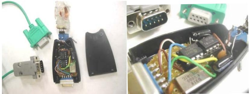
**Figura 2.17.** Circuito final del oscilador y frecuencímetro ensamblado.
