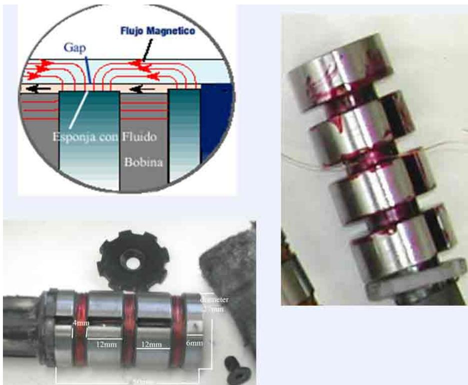
**Figura 5.10.** Arriba: detalle del campo magnético generado por la bobina del pistón.
