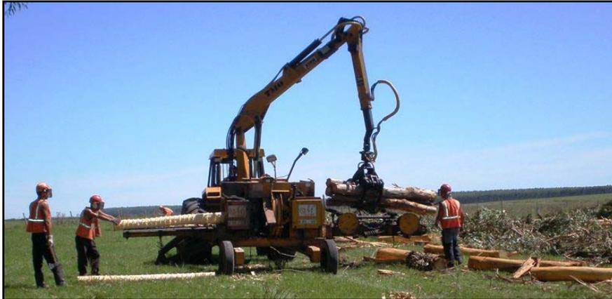
**Peladora o Descortezadora de troncos en acción**
