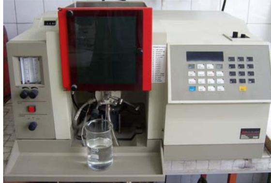
Figura 3.7. Espectrofotómetro modelo 3100 de Perkin-Elmer
