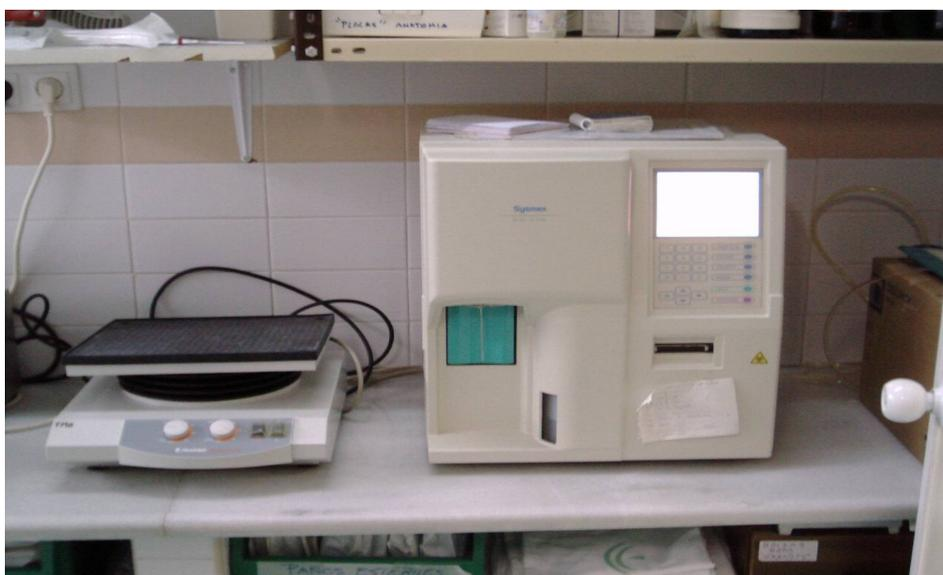
El equipo SYSMEX KX 21N (Roche, Barcelona, España) es un analizador hematológico automatizado que utiliza tecnología de impedancia para el recuento celular sanguíneo (274). Esta tecnología se basa en el hecho de que las células sanguíneas son malas conductoras de la electricidad, mientras que el líquido diluyente es un buen conductor eléctrico.
