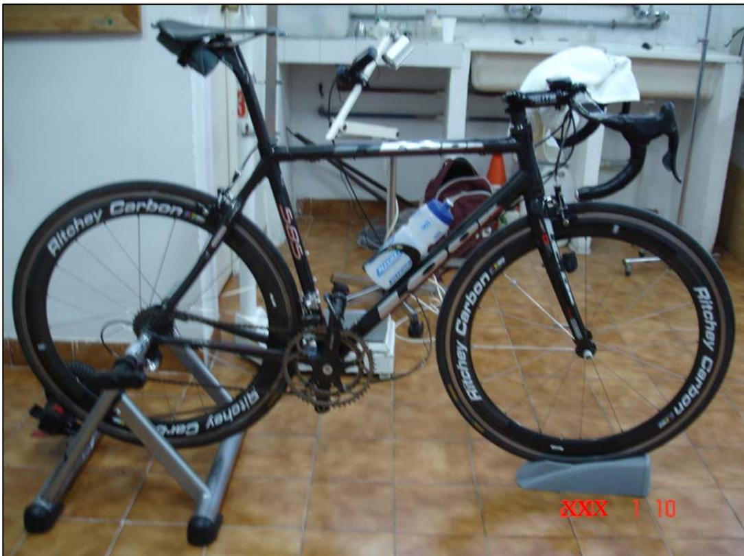
**Figura 5.6.** Imagen del rodillo y su adaptación a la bicicleta utilizados para realizar las pruebas.
