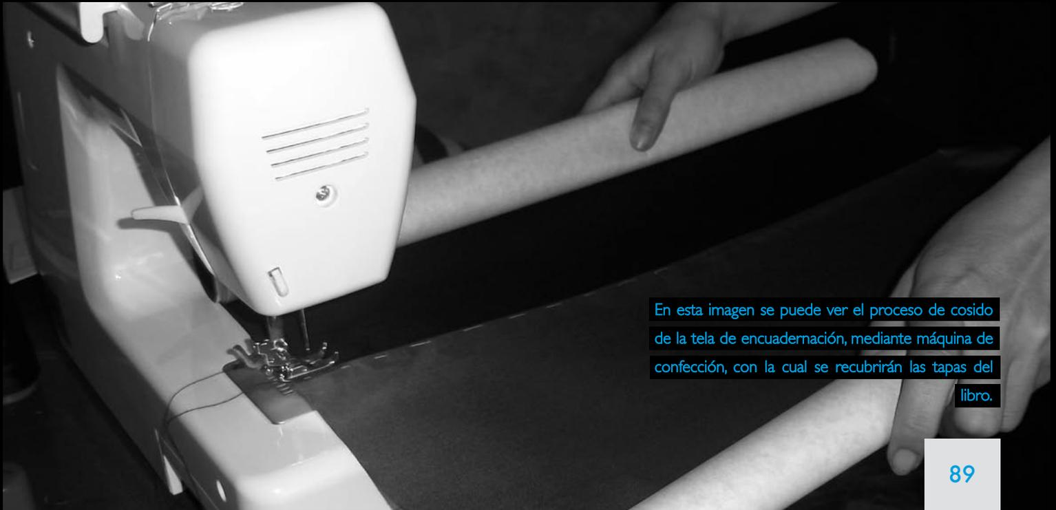
En esta imagen se puede ver el proceso de cosido de la tela de encuadernación, mediante máquina de confección, con la cual se recubrirán las tapas del libro.
