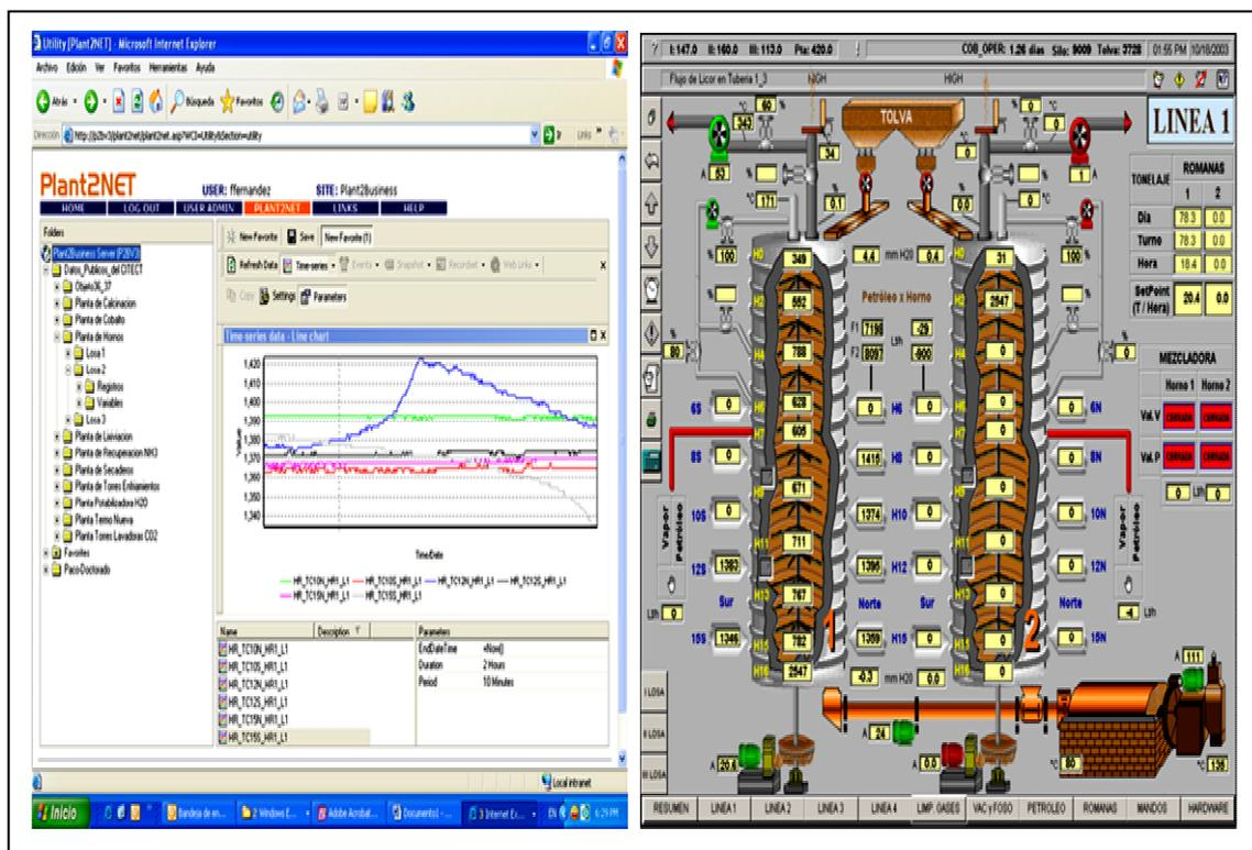
Figura 3-3: Vista de un típico registro de variables medidas en tiempo real
