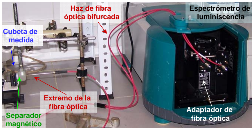
Fig. BII. 7. Fotografía del sistema de fibra óptica diseñado para la caracterización espectroscópica de las fases sensoras magnéticas
