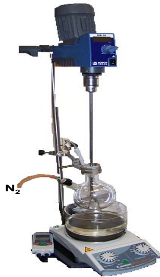
Fig. BII. 3. Fotografía real del sistema usado para llevar a cabo la generación de nanopartículas magnéticas.
