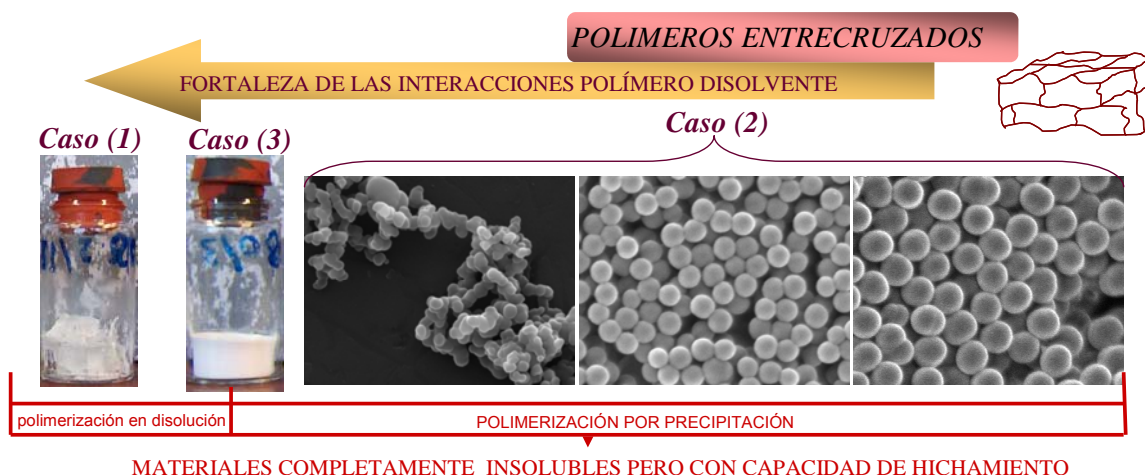
Fig. 21. Materiales poliméricos obtenidos en función de las interacciones polímero disolvente a lo largo de la polimerización en disolución
