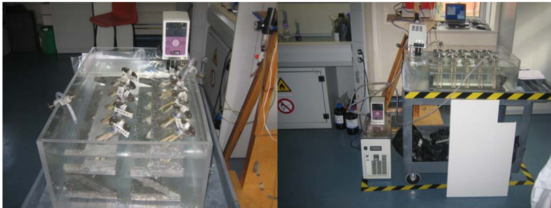
Figura 155. Fotografía del baño termostático utilizado en los experimentos.
