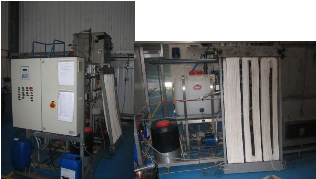
Figura 141. Fotografía de la planta piloto y del módulo de membrana utilizados en el estudio de permeabilidad e integridad de las membranas.
