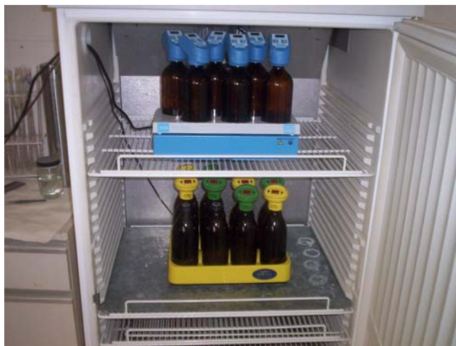
Figura 19. Método manométrico determinación DBO 5 .
