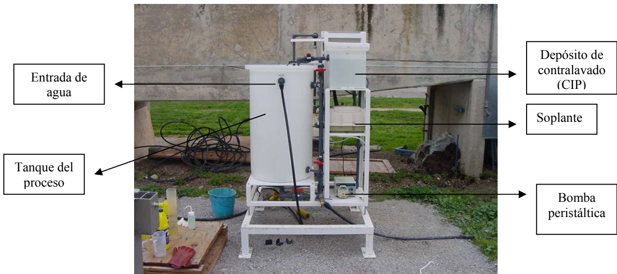
Figura 43. Planta Piloto Biorreactores de membrana
