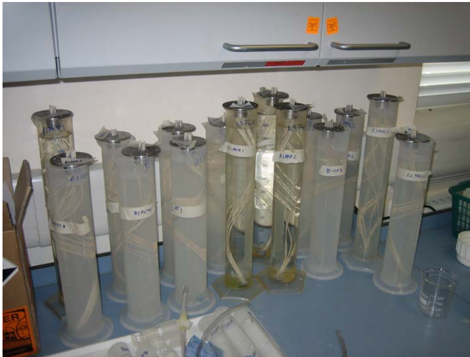
Figura 147. Fotografía de 15 módulos fabricados a partir de las membranas de fibra hueca del módulo de escala real.
