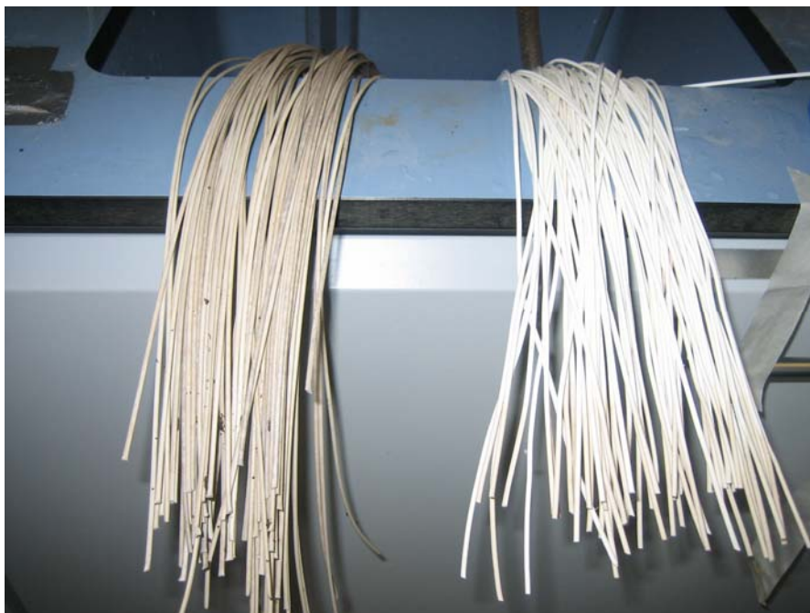
Figura 156. Fotografía donde se observan las membrana de fibra hueca utilizadas en los experimentos; a la izquierda antes de las limpiezas químicas y a la derecha después de las limpiezas químicas.
